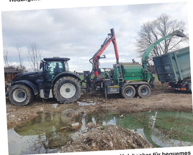
Valtra S394 mit Rückfahreinrichtung am Holzhacker für bequemes Arbeiten aus der Kabine heraus.
