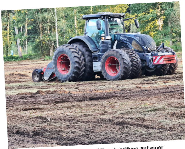
Valtra S394 mit Forstfräse und Zwillingsbereifung auf einer Rodungsfläche.
