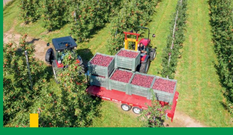
Die geringe Breite ist nur eine wichtige Eigenschaft. Für den Fahrer, der den Traktor bedient, zählt auch die Übersicht beim Arbeiten und die komfortable Bedienung. Auch die Lenkung ist besonders, denn der Platz zum Drehen und Wenden ist sehr gering, also muss die Maschine besonders wendig sein. Das können die Traktoren der F-Serie, sie haben ein speziell geformtes Fahrwerk.
