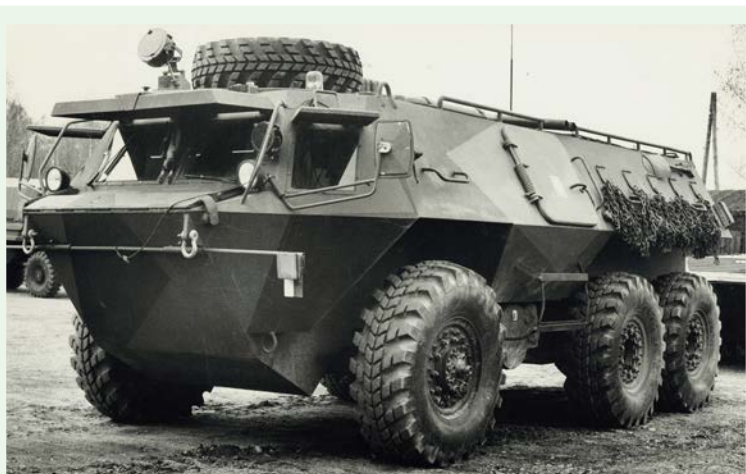
Der Panssari-Valmet, oder Valmet 1912-6, basierte auf dem sechsrädrigen Valmet 1502. Nur ein Prototyp wurde für Tests durch die finnischen Streitkräfte hergestellt, bei denen er gegen den LKW-basierten Panssari-Sisu verlor.
