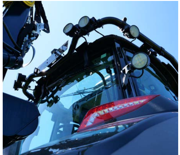
Die SkyView-Kabine bietet eine gute Sicht auf den Kran und ist durch einen Metallbügel geschützt. Die LED-Leuchten sorgen für gute Sichtverhältnisse beim Arbeiten im Dunkeln.
