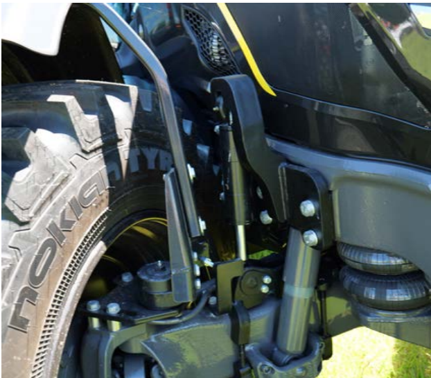
Die Vorderachsverblockung sorgt für stabilen Stand während den Kranarbeiten.
