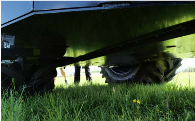
Der Unterboden des Schleppers wurde mit dicken Stahlplatten verstärkt.
