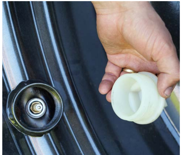
Das Radventil wird von einer Rohrmuffe und einer aufschraubbaren Ventilschutzkappe geschützt.
