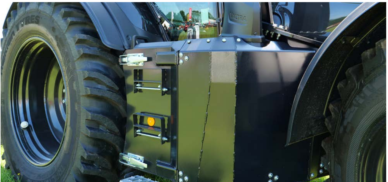
Die Seitenschutzplatte für das Batterie- und Werkzeugfach kann in Fahrtrichtung geöffnet werden.
