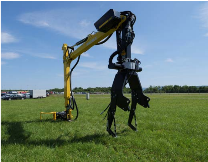
Der Kran ist komplett demontierbar und kann abgestellt werden. Der Schlepper steht dann auch für andere Anwendungen zur Verfügung.
