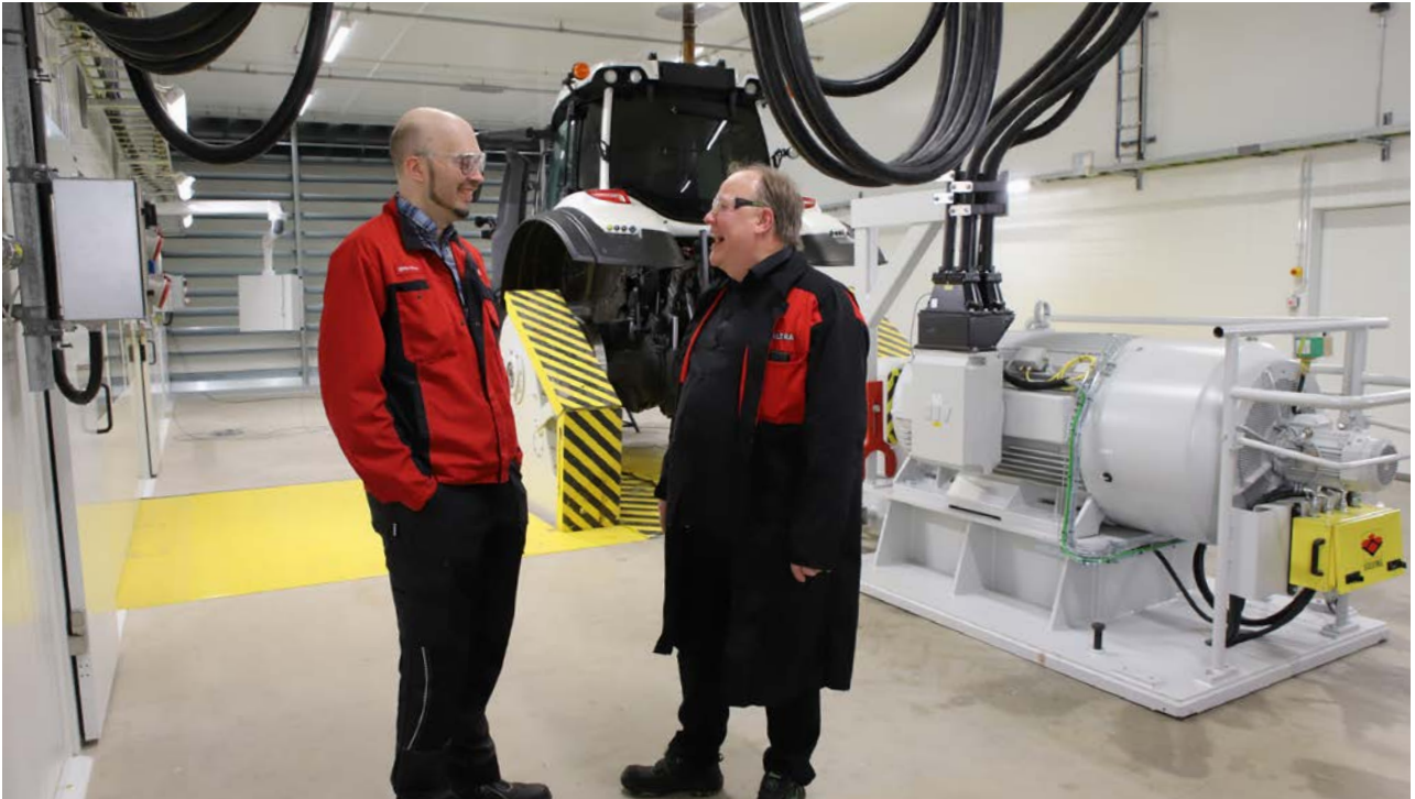
Technischer Leiter Mikko Rintoo und Teamleiter Kimmo Kurkinen sind begeistert vom neuen Klimalabor. Das neue Labor ermöglicht es, Traktoren unter sommerlichen, herbstlichen, winterlichen und frühlingshaften Bedingungen auf Temperatur, Luftfeuchtigkeit und Windverhältnissen zu testen.
