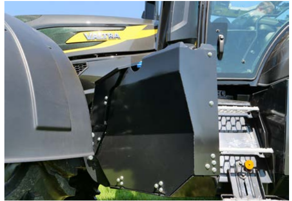
Auch der Tank ist dank Stahlschutz vor Steinen, Ästen oder Holzstämmen sicher.
