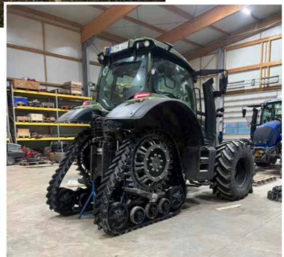
Umbau der N-Serie auf Raupenlaufwerke. Mit einer Spurbreite von 1,5 Metern wird dieser Schlepper für den Anbau und Pflege von Kartoffeln eingesetzt.
