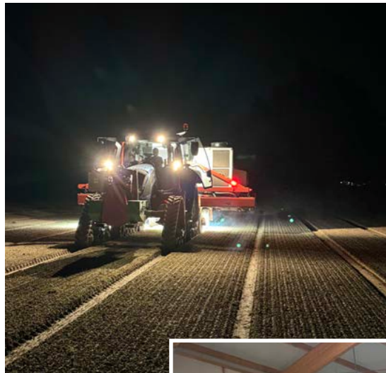
Umbau der N-Serie auf Raupenlaufwerke. Mit einer Spurbreite von 1,5 Metern wird dieser Schlepper für den Anbau und Pflege von Kartoffeln eingesetzt.
