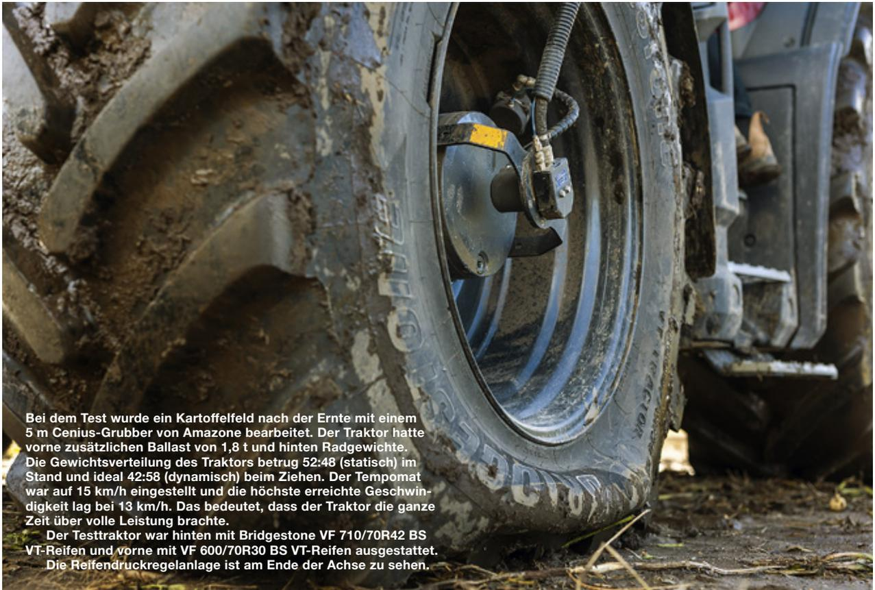
Bei dem Test wurde ein Kartoffelfeld nach der Ernte mit einem 5 m Genius-Grubber von Amazone bearbeitet. Der Traktor hatte vorne zusätzlichen Ballast von 1,8 t und hinten Radgewichte. Die Gewichtsverteilung des Traktors betrug 52:48 (statisch) im Stand und ideal 42:58 (dynamisch) beim Ziehen. Der Tempomat war auf 15 km/h eingestellt und die höchste erreichte Geschwindigkeit lag bei 13 km/h. Das bedeutet, dass der Traktor die ganze Zeit über volle Leistung brachte.
