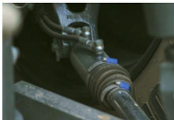
Über Unlimited sind auch hydraulische Seitenstreben & ISOBUS Steckdosen erhältlich.
