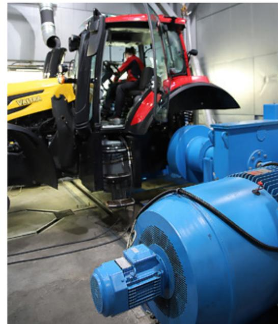
Jan-Erik Karjula fährt einen Traktor auf dem Prüfstand. Die Ergebnisse werden genutzt, um sowohl den Traktor als auch den Simulator weiter zu entwickeln.
