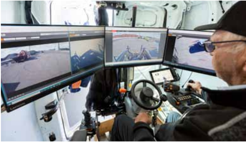
Die Traktorsteuerung befindet sich hier in einem Transporter. Es ist auch möglich, einen Traktor fernzusteuern, indem man die Steuerungen in einem anderen Traktor verwendet oder, mit größeren Einschränkungen, ein tragbares Steuergerät einsetzt.
