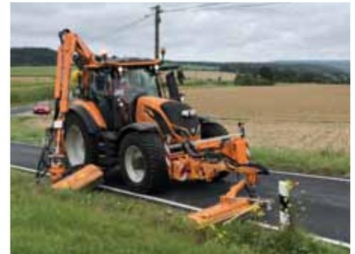
Valtra T234 mit Mulag Heckböschungsmäher GHA 700 und Frontböschungsmäher MRK 300 G im Einsatz.
