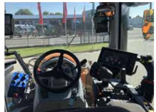
Fahreransicht mit Kameradisplays (oben links & rechts), Mulag m|control (unten links), SmartTouch-Armlehne und separatem Bedienjoystick (unten rechts).
