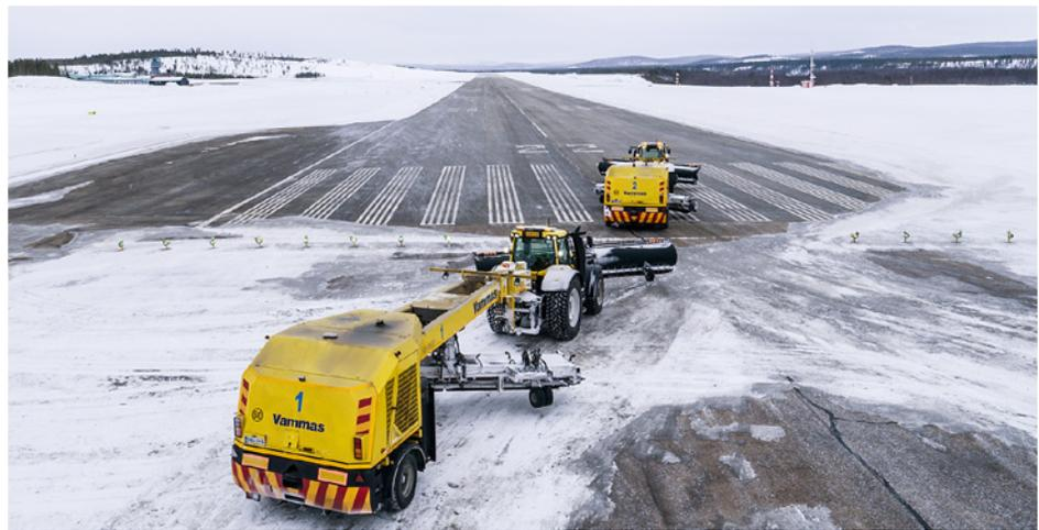
Die automatische Lenkung von Valtra Guide ist eine große Hilfe beim Räumen von Landebahnen, auch mit einem Fahrer. Das System erkennt die Ränder und die Mitte der Landebahn, auch wenn diese vollständig mit Schnee bedeckt ist. GPS-basierte Teilbreitenschaltung kann außerdem sicherstellen, dass genau die richtige Menge an Enteisungsmitteln angewendet wird. Das verringert sowohl die Umweltbelastung als auch die Betriebskosten.
