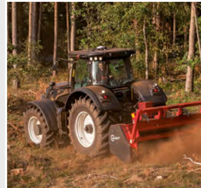
Das Spitzenmodell der S-Serie und der damit stärkste Valtra aller Zeiten leistet bis zu 400 PS und 1600 Nm Drehmoment mit Boost. Der Motor hat einen Bi-Turbo mit elektronisch geregelter Wastegate.
