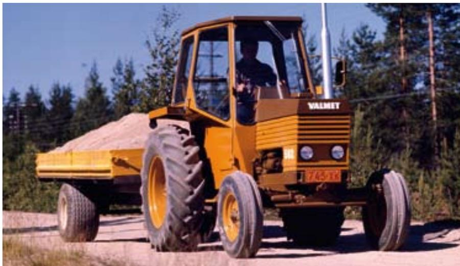
**Der Valmet 502 hob sich von anderen Traktoren seiner Zeit ab. Der Valmet-Dreizylindermotor 310B hatte 2,7 Liter Hubraum und erzeugte 54 PS (SAE) bei 2 300 U/min. Das teilsynchronisierte Getriebe verfügte über sechs Vorwärts- und zwei Rückwärtsgänge. Unbeladen brachte der Traktor 2 495 kg auf die Waage.**
