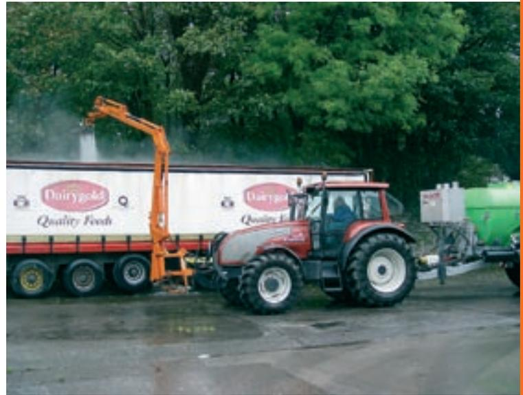
**Die Reinigungseinheit kann einfach an den geparkten Fahrzeugen vorbei fahren.**
