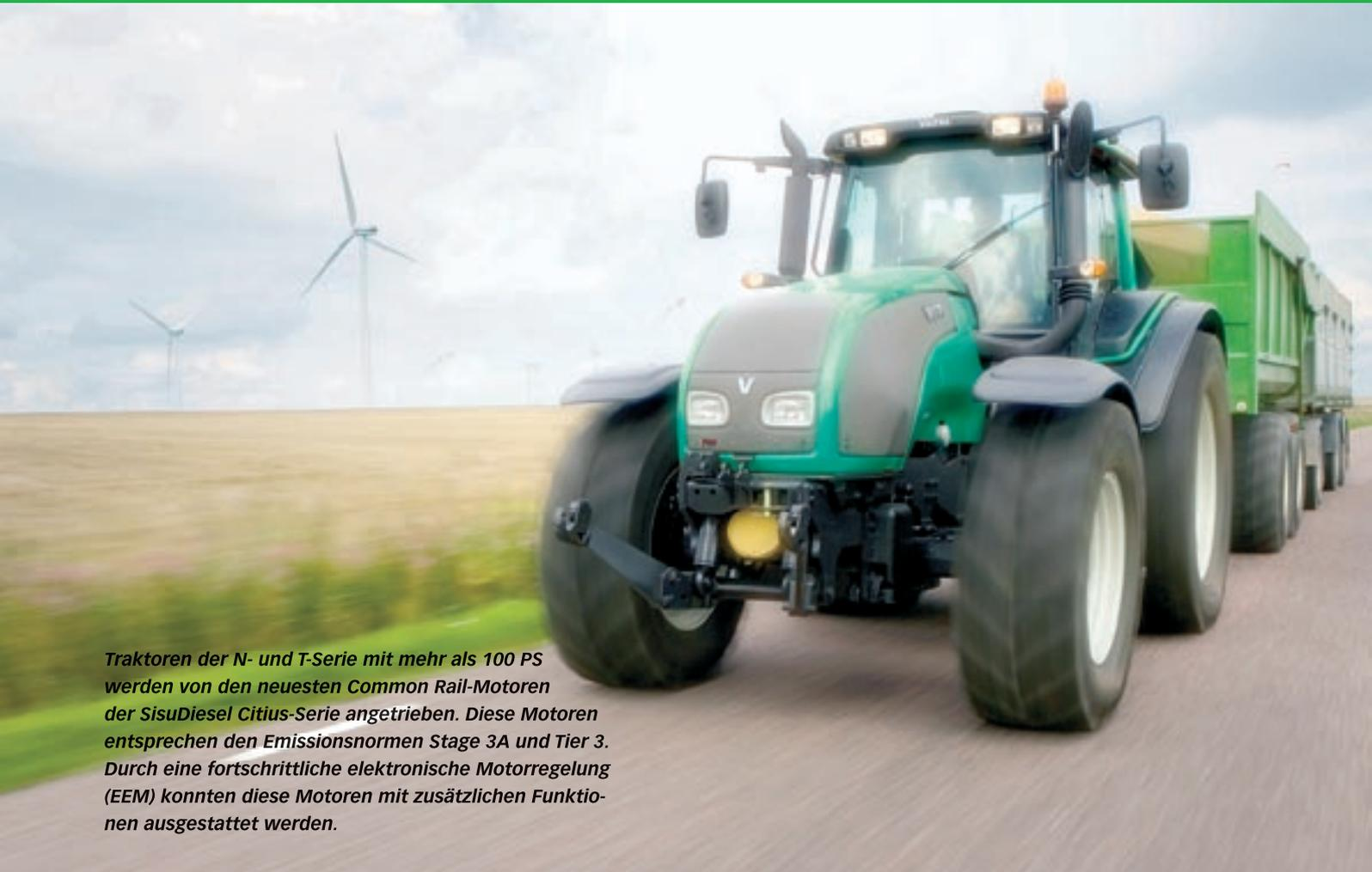
**Traktoren der N- und T-Serie mit mehr als 100 PS werden von den neuesten Common Rail-Motoren der SisuDiesel Citius-Serie angetrieben. Diese Motoren entsprechen den Emissionsnormen Stage 3A und Tier 3. Durch eine fortschrittliche elektronische Motorregelung (EEM) konnten diese Motoren mit zusätzlichen Funktionen ausgestattet werden.**
