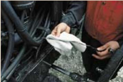
Prüfen Sie den Motorölstand. Stellen Sie den Traktor ein paar Minuten vorher ab, damit sich das Öl in der Ölwanne sammeln kann. Der Prüfstab und die Öleinfüllöffnung befinden sich auf der linken Seite des Motors. Der Ölstand muss sich zwischen den beiden Markierungen auf dem Prüfstab befinden.
