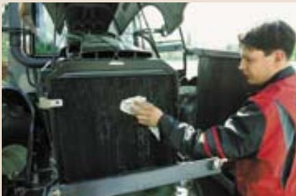
Reinigen Sie die Kühlelemente. Der vordere Zusatzölkühler kann nach vorn geklappt werden und das Kühler für die Klimaanlage kann seitlich geschwenkt werden, wenn die obere Befestigung gelöst wird. Der Kühler für das Getriebe- und Hydrauliköl kann genauso seitlich geschwenkt werden. Zum Reinigen der Kühlergrills nehmen Sie am besten Druckluft, einen weichen Lappen oder eine weiche Bürste. Hochdruckreiniger dürfen nicht verwendet werden, weil damit die Kühlrippen beschädigt werden könnten.
