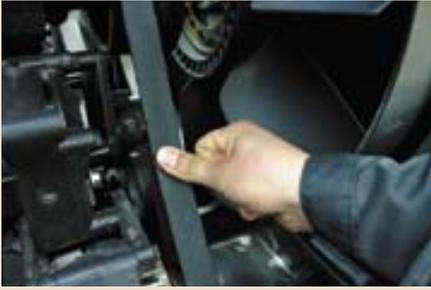
**Prüfen Sie die Spannung des Keilriemens.** Der Riemen für die Lichtmaschine sollte an der rechten vorderen Riemenscheibe geprüft werden. Der Riemen darf etwa zwei Zentimeter Spiel haben, wenn er mit dem Daumen gedrückt wird. Der Keilriemen hat eine automatische Spannvorrichtung. Prüfen Sie auch, ob der Riemen beispielsweise nicht beschädigt, eingegrissen oder ölig ist.
