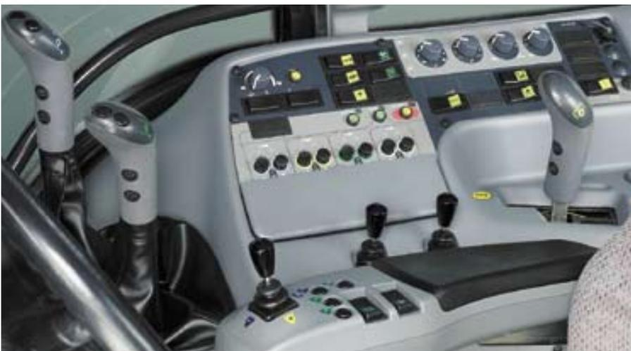
**Sauer-Danfoss liefert unter anderem das Lenkorbitrol (Lenkventil) für alle Valtra Modelle. Darüber hinaus liefern Sie Prioritätsventile für fast alle Modelle – sowie hydraulische Proportionalventile und Joy-Stick für die Valtra Traktorserien S, T und M.**
