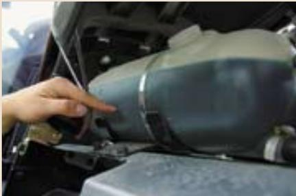
Prüfen Sie den Stand der Kühlflüssigkeit. Der Ausgleichsbehälter ist an der rechten Seite des Motors angebracht. Die Markierung auf dem Tank zeigt der untere Level der Kühlflüssigkeit in kaltem Zustand, das Level bei hoher Temperatur kann wesentlich höher als die untere Markierung liegen. Verwenden Sie niemals Wasser allein als Kühlmittel.
