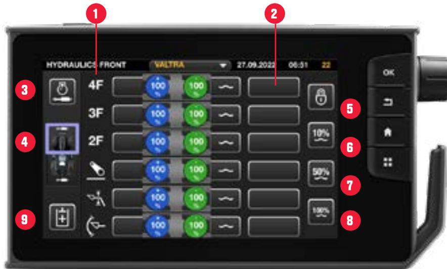
1. Auflistung der Zusatzsteuerventil-Nummer oder Funktion des Ventils
