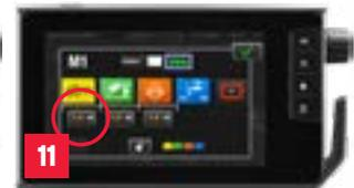
**TIPP:** Die U-Pilot Sequenz ist unter einem Profil gespeichert. Wechseln Sie die Arbeit, so können Sie auch das Profil wechseln, um immer alle Einstellungen passend parat zu haben. So müssen die M-Tasten nicht immer wieder manuell neu belegt werden.
