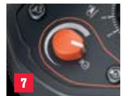
**HINWEIS:** Beim stationären Einsatz der Zapfwelle stoppt der Anwesenheitssensor normalerweise die Zapfwelle, wenn Sie vom Fahrersitz aufstehen. Um dies zu vermeiden, drücken Sie den Zapfwellenschalter und halten ihn drei Sekunden lang in der EIN-Stellung, bevor Sie den Sitz verlassen (die Zapfwelle muss dabei in Betrieb sein).
