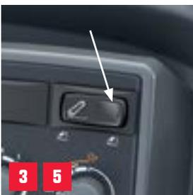
**HINWEIS:** Der Entriegelungshebel für die Pick-up Hitch dient in Deutschland als Fernbedienhebel für die automatischen Anhängerkupplungen A10 und A11.
