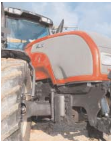
Die Luftfederung (Option) spricht sehr fein an. Sperren geht aber nur manuell.
