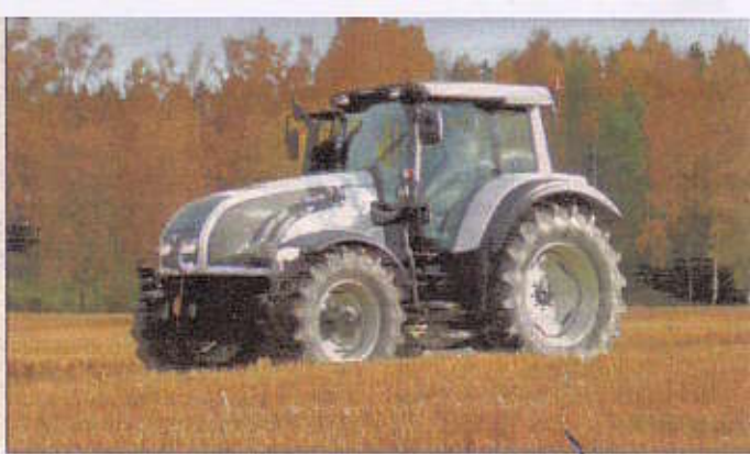
Die Valtra-Direct-Serie hat ein eigens entwickeltes stufenloses Getriebe.
