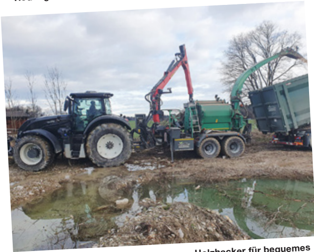
Valtra S394 mit Rückfahreinrichtung am Holzhackler für bequemes Arbeiten aus der Kabine heraus.
